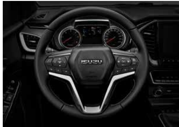
Električna servo asistencija koja pruža bolji osećaj u svim uslovima vožnje. "Lakši volan" pri malim brzinama i parkiranju, a "teži" pri većim brzinama, obezbeđuje idealan odnos udobnosti i bezbednosti
