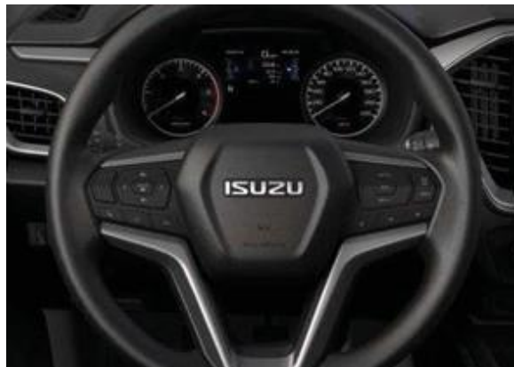
Električna servo asistencija koja pruža bolji osjećaj u svim uslovima vožnje. "Lakši volan" pri malim brzinama i parkiranju, a "teži" pri većim brzinama,
