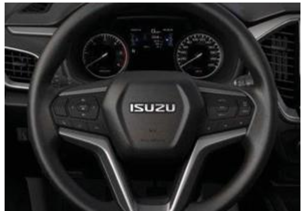
Električna servo asistencija koja pruža bolji osećaj u svim uslovima vožnje. "Lakši volan" pri malim brzinama i parkiranju, a "teži" pri većim brzinama, obezbeđuje idealan odnos udobnosti i bezbjednosti
